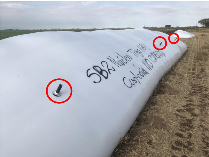
○ Lanza con sensores de movimiento, temperatura, humedad y cantidad de CO 2
